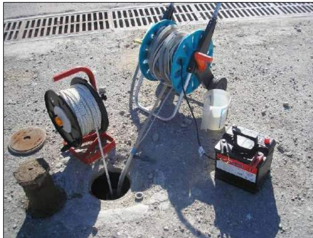
Photo 35 : Matériel de prélèvement des eaux souterraines
